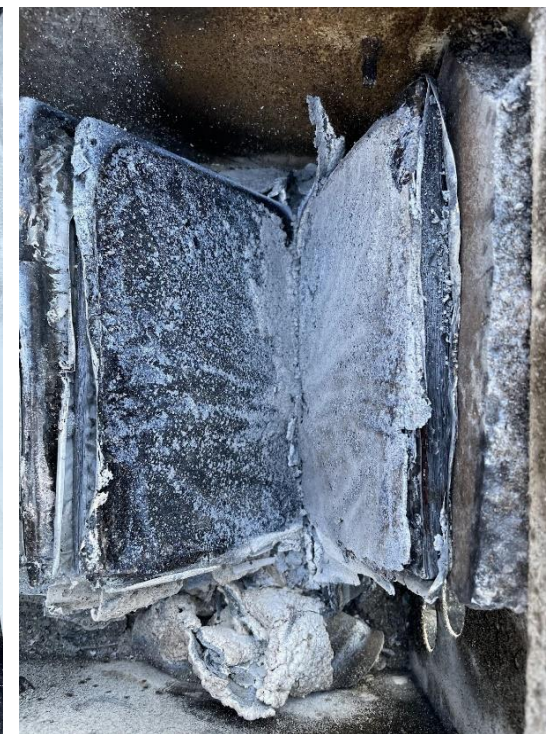
Внешний вид сборки аккумуляторов после испытания
