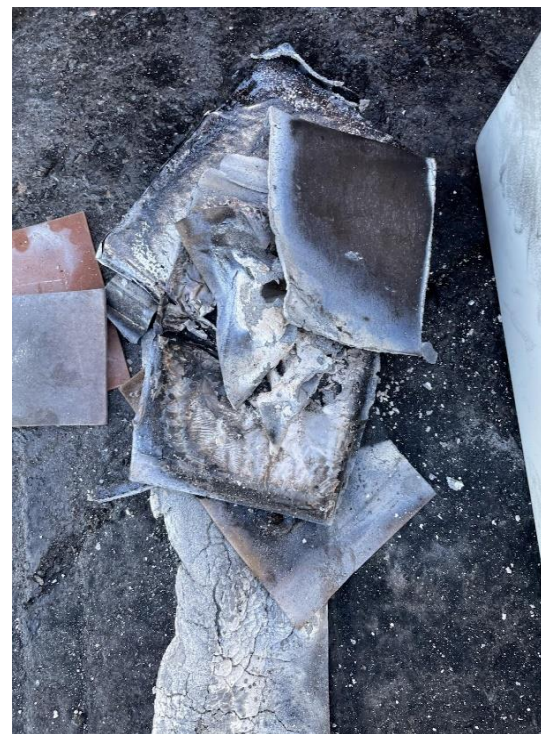
Внешний вид сборки аккумуляторов после испытания
